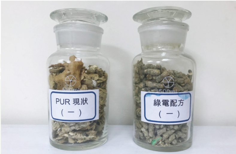
▲ 右側為燃料棒，除高熱值特性，並加入研究配方去除 PUR 燃燒所產生的空氣污染物
